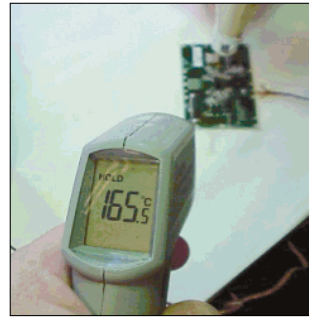
Bild 11: Temperaturkontrolle mit Thermoelement und optionalen Infrarot-Tempersensoren
